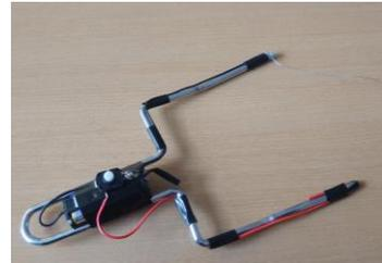
ミニライトの電池ボックスとスイッチ 部品をコードでつなぐ フレームに固定する
